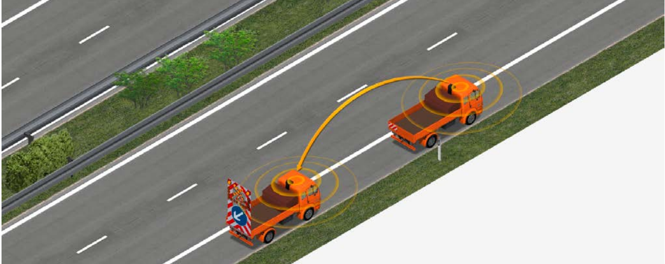
WLAN-Kommunikation zwischen Arbeitsfahrzeug und fahrerlos automatisiert fahrendem Absicherungsfahrzeug
