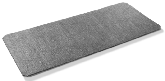
Zur Verbesserung der Elektrodenleistung wurde ein Kohlefaser-Filz mit einer Kohlenstoffkomponente beschichtet.
