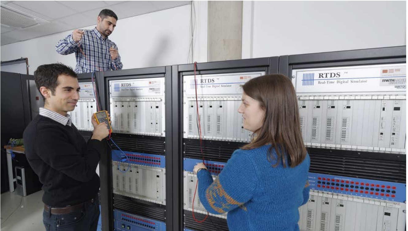
Die Projektmitarbeiter nehmen den digitalen Echtzeitsimulator im Labor des „Institute for Automation of Complex Power Systems“ an der RWTH Aachen in Betrieb.
