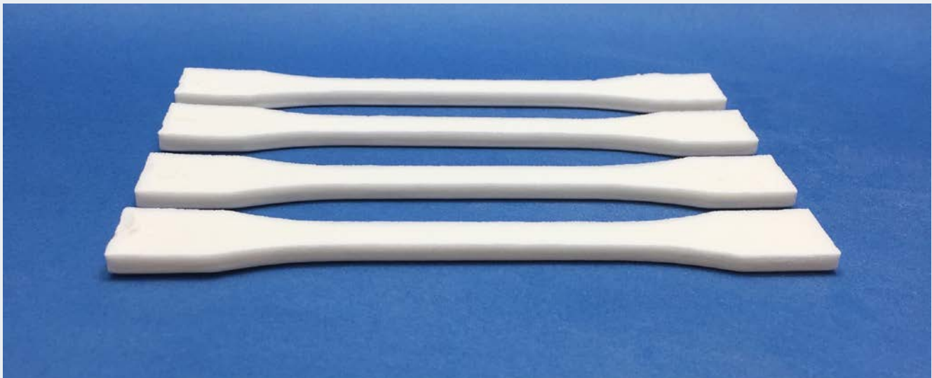
Im Forschungsvorhaben PolySLS hat das Wissenschaftsteam im selektiven Lasersintern (SLS)-Verfahren Zugprüfstäbe aus dem neuartigen Kunststoffpulver hergestellt.
