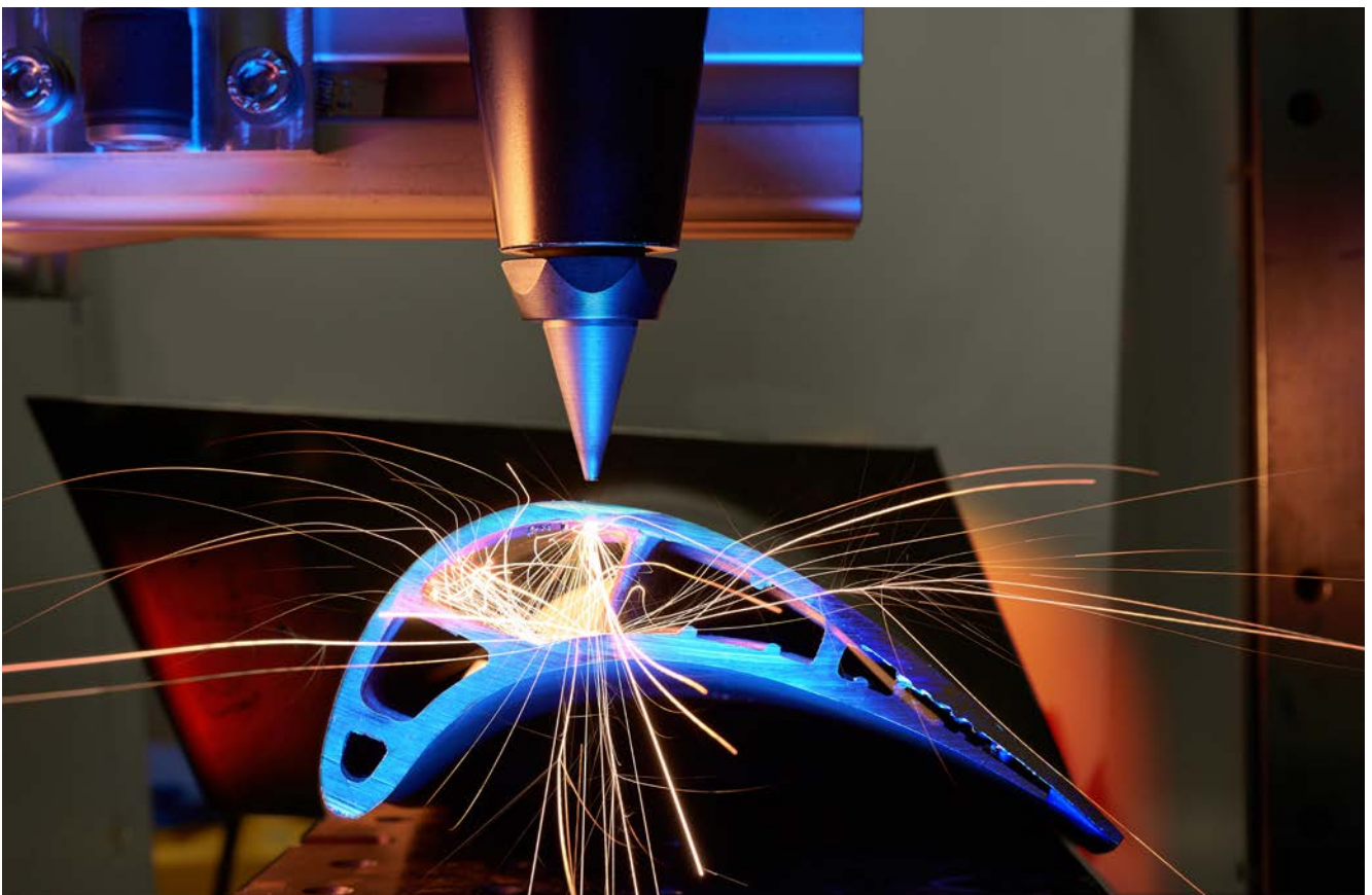
Mit ultrakurzgepulstem Laserstrahlbohren werden qualitativ hochwertige Bohrungen ohne Risse oder Schmelzschichten erzeugt.
