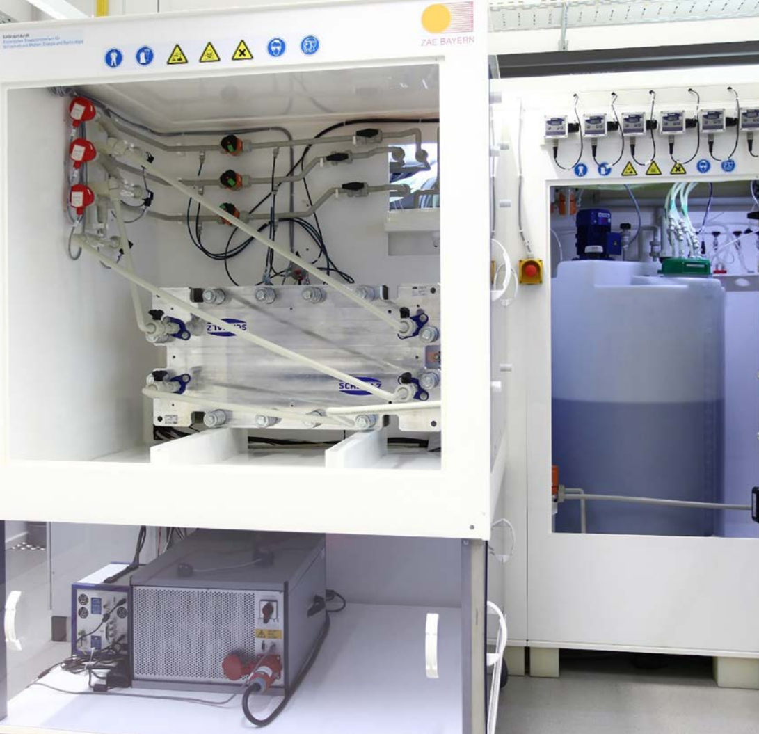
Mit dem Redox-Flow-Testsystem können Wandlereinheiten mit industriellen Dimensionen vermessen werden.
