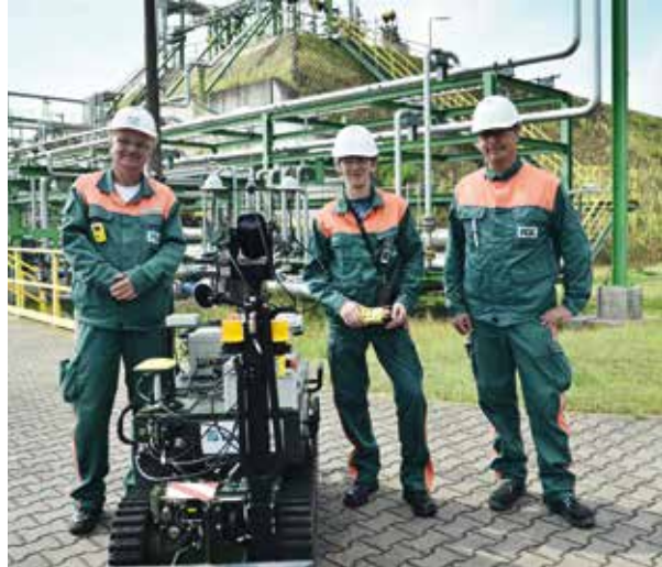
RoboGasInspector findet Gaslecks
