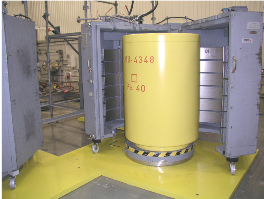
Abb. 2: Vakuumtrocknungsanlage KETRA, MOSAIK® II-Behälter mit Heizmantel
